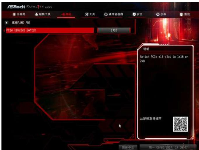
PCIe x16/2x8 Switch( PCIe x16/2x8 切换) (仅锐龙 AMD Ryzen 处理器
